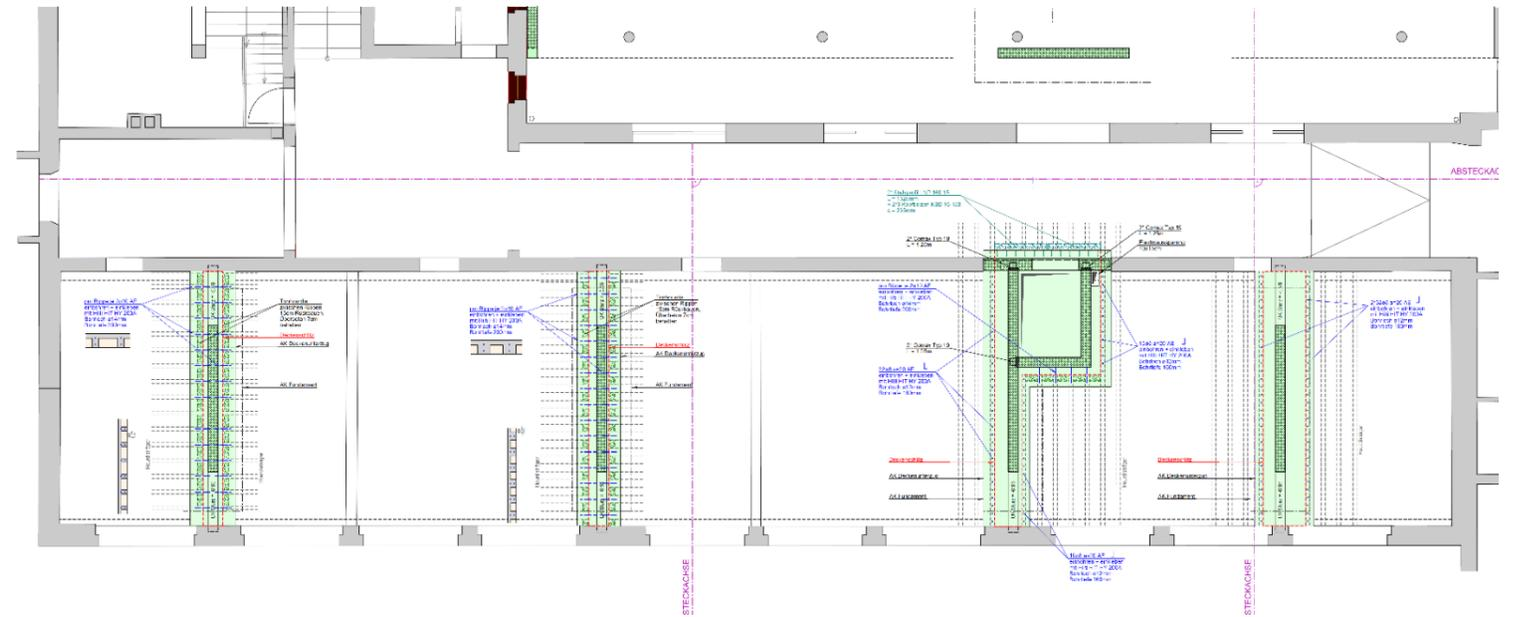
Aussteifungsscheiben aus Stahlbeton im Altbau 1928
